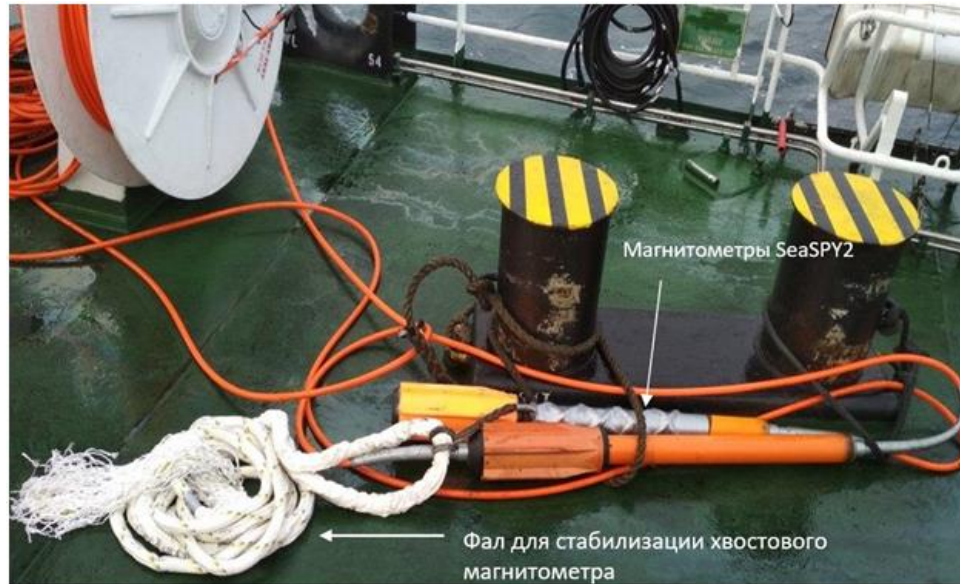
Рис. 1.3. Магнитометры SeaSPY2, подключенные в режиме продольного градиентометра (по материалам ОАО «МАГЭ», 2019)
